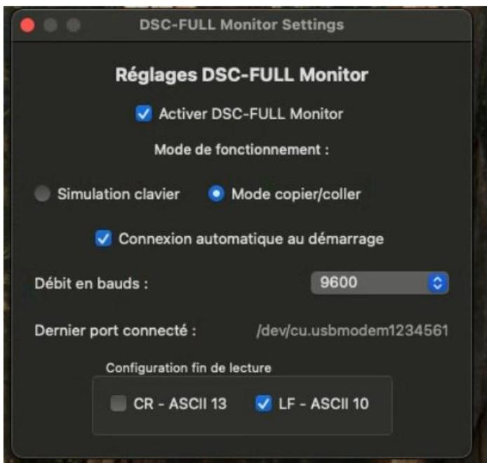
Le port COM et la vitesse sont gérés par le logiciel.
